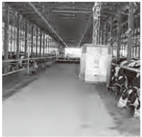
自動給餌機が牛舎内を自動で動き、牛に餌を与えています。
