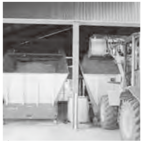
ダンプボックスにTMR飼料が投入され、自動給餌機に送られます。
