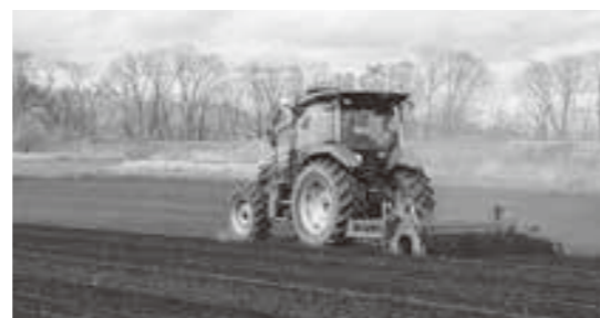
無人で旋回・走行を繰り返しながら整地作業をするロボットトラクター
