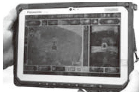
タブレット端末で稼働面積や時間、運転席からの映像等の確認が出来ます。
